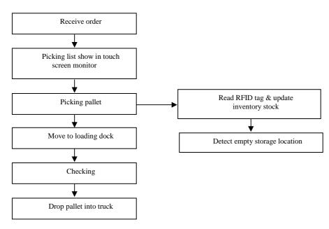
Fig. 10. The picking process after using RFID system Rys. 10. Proces podjęcia po użyciu systemu RFID
