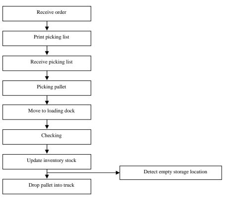
Fig. 3. The picking process Rys. 3. Proces podjęcia
