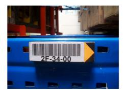
Fig. 5. Location tag Rys. 5. Tag lokalizacji
