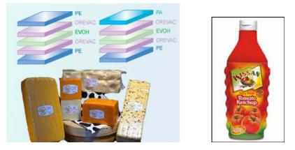
Fig. 3. Ethylene-vinyl alcohol copolymer (EVOH) used in shrinkable films and plastic containers Rys. 3. Zastosowania kopolimeru EVOH w kurczliwych foliach i opakowaniach plastikowych
