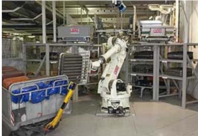
Fig. 5. LÖDIGE-ALPHA-PACKER for baggage-handling (Figure of LÖDIGE Industries GmbH) Rys. 5. Robot do załadunku bagażu LÖDIGE-ALPHA-PACKER (zdjęcie LÖDIGE Industries GmbH)
