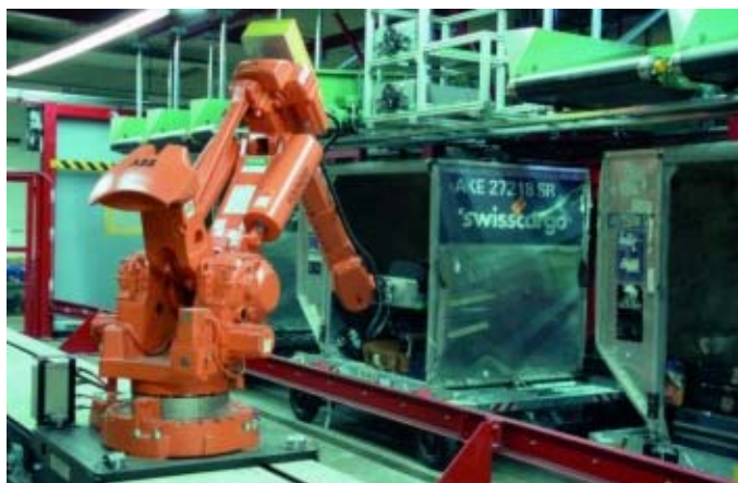
Fig. 6. ONERO system solution “baggage-handling” in Zurich Rys. 6. System ONERO stosowany w obsłudze bagażu w Zurychu
